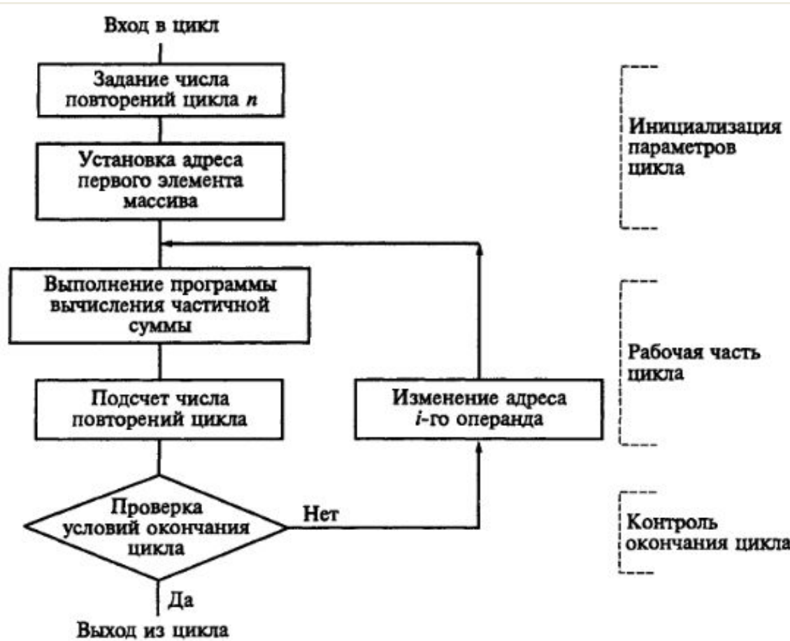
Рис. 6 – Пример использования косвенной адресации в алгоритме циклической обработки при вычислении
