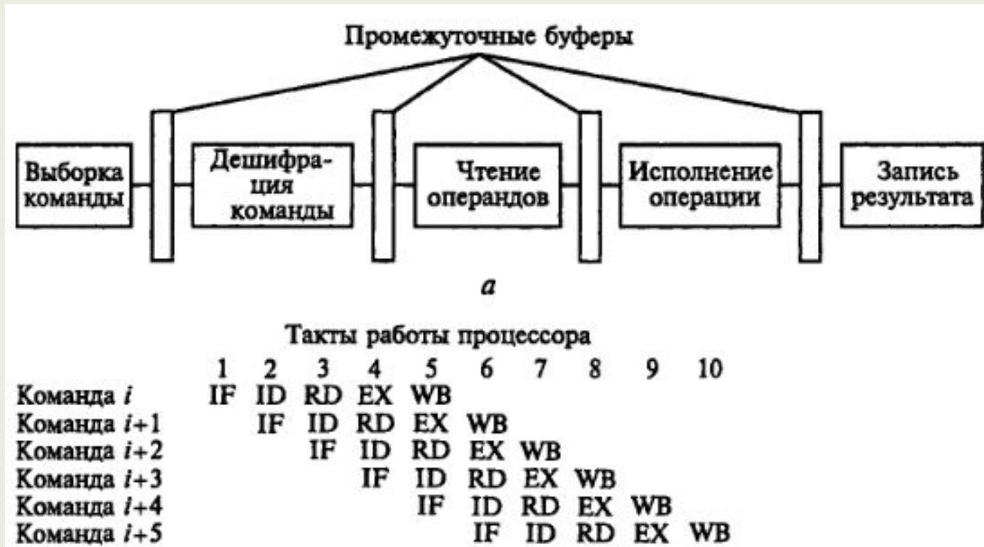
Рис. 8 – Принцип работы конвейера
