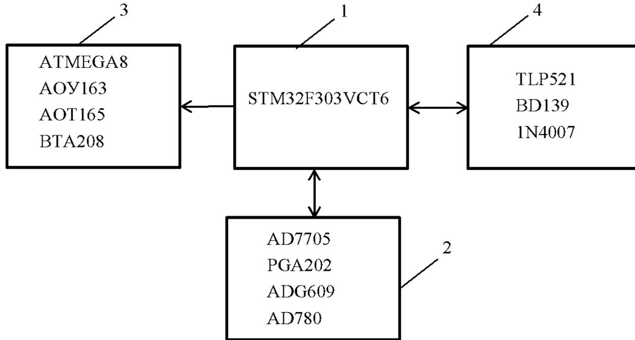
**Рис. 1 – Структурная схема блока управления и измерений**
