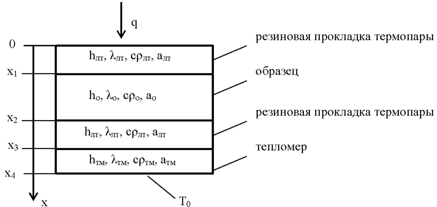
Рис. 1 – Тепловая схема эксперимента
