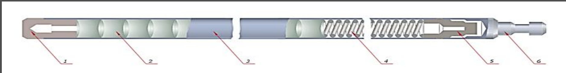
Устройство твэла реактора РБМК: 1 — заглушка; 2 — таблетки диоксида урана; 3 — оболочка из циркония; 4 — пружина; 5 — втулка; 6 — наконечник.
