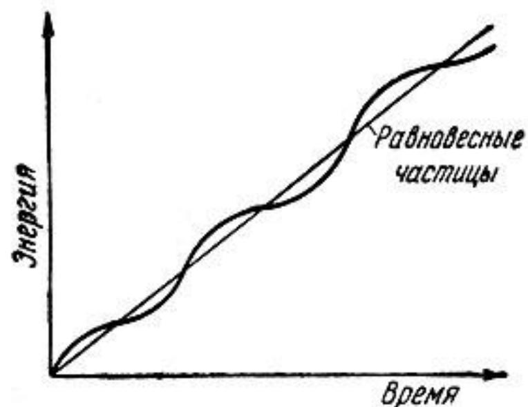
Явление автофазировки, открытое Векслером и независимо подтвержденное зарубежными учеными, позволило создать принципиально новый тип ускорителей – циклотроны, позволяющие нарастить энергию ускоряемых частиц за счет резонанса, возникающего при автофазировке, т.е. подстройке характеристик частиц под фазу.
