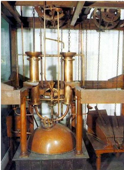
Макет паровой машины Ползунова привода в движение мехов плавильных печей
