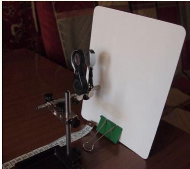
Перемещая рассеивающую линзу, получим резкое изображение на экране.
