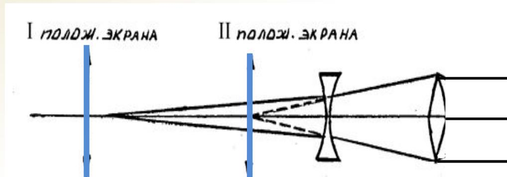
Оптическая сила системы собирающей и рассеивающей линз, расположенных на расстоянии  $r$
