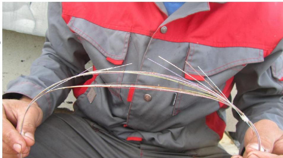
*Оптические волокна, повреждённые в результате небрежной разделки кабеля (была неверно выставлена длина лезвия стриппера для снятия внутренней оболочки кабеля, в результате чего прорезались модули и повредилась часть волокон)*
