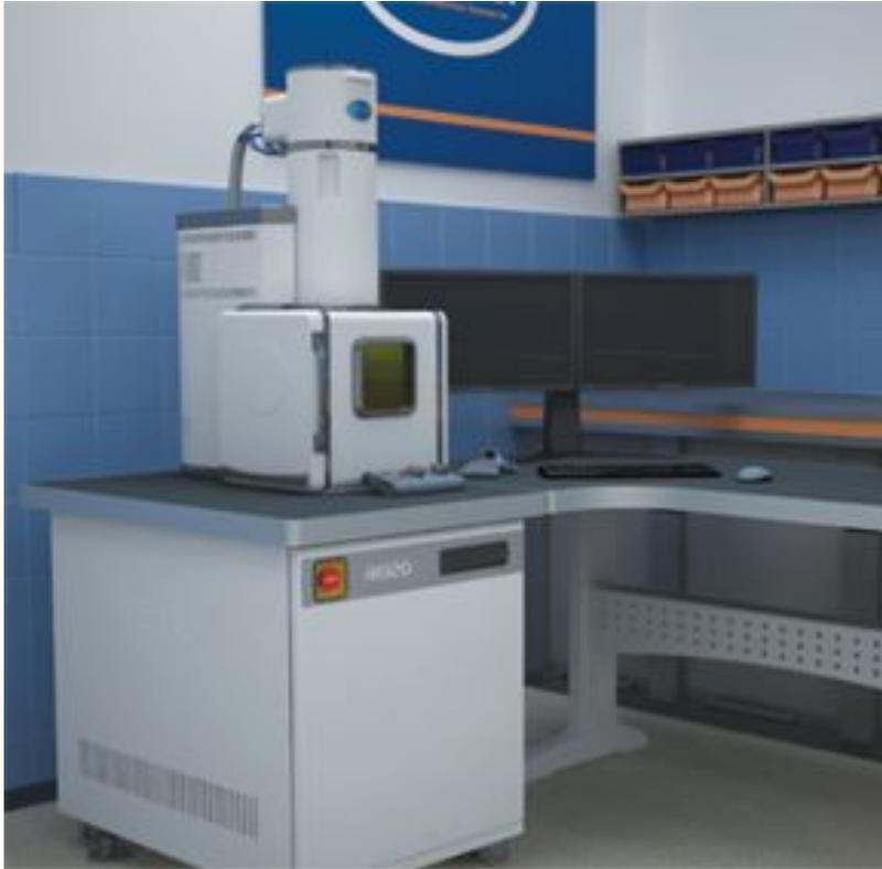
Электронно-лучевая технологическая установка 4E120 предназначена для сварки, пайки, термообработки в вакууме изделий из конструкционных сталей, из сплавов меди, алюминия, тугоплавких и активных металлов толщиной от 0,05 до 10 мм.
