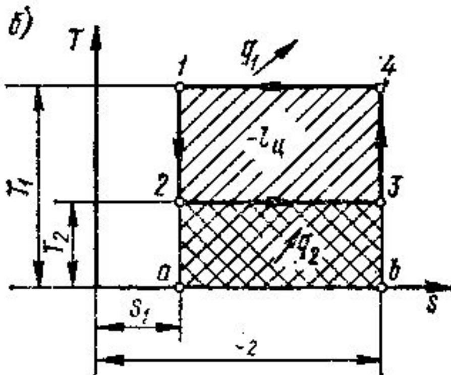
**3 - 4** Газ подвергается сжатию по адиабате и его температура от  $T_2$  повышается до  $T_1$
