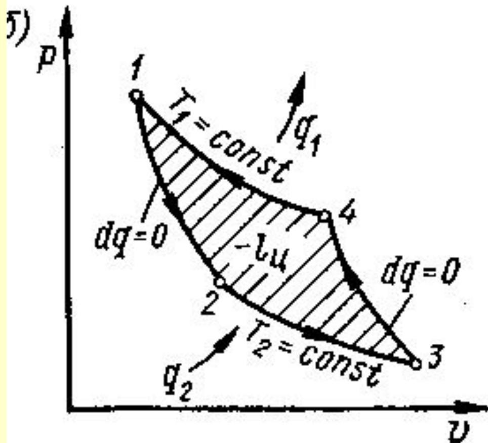
**1 - 2** Рабочее тело расширяется адиабатно, совершая работу расширения за счет внутренней энергии, и охлаждается от температуры  $T_1$  до  $T_2$ .
