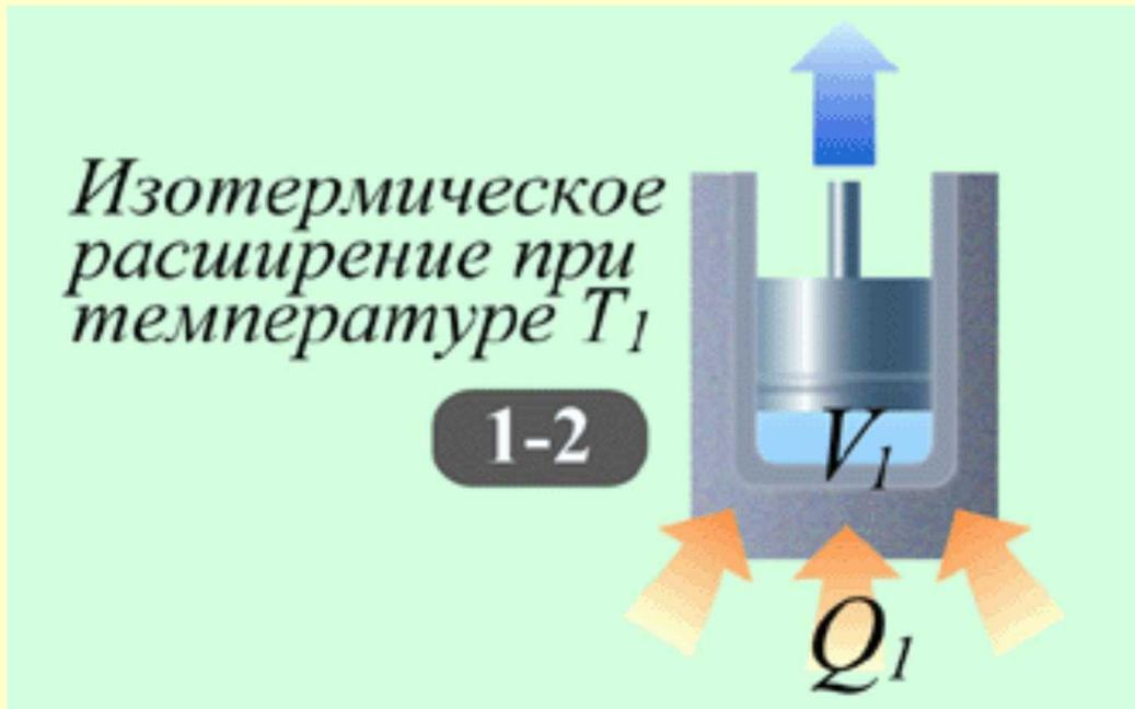
При изотермическом расширении газ забирает от источника теплоту
