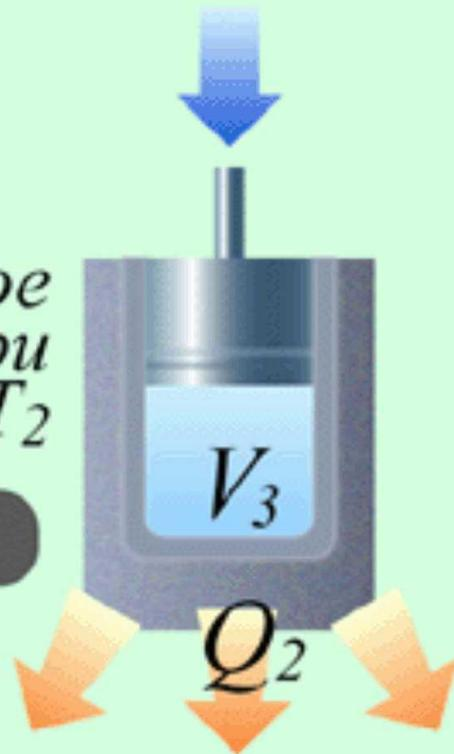
Изотермически сжимаем рабочее тело по изотерме, отводя при этом холодному источнику теплоту
