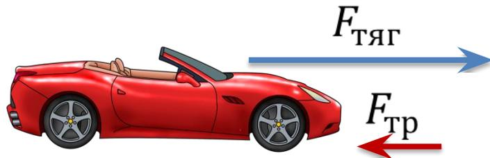
$$F_{\text{р}} = F_{\text{тяги}} - F_{\text{тр}} = ma$$
