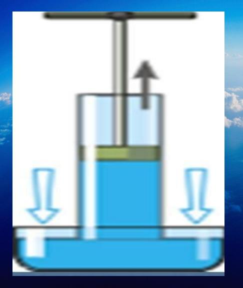
• Объясните, почему, если поднимать поршень вверх, то вода тоже поднимается вслед за поршнем? В 1654 г. Отто Герике в городе Магдебурге, чтобы доказать существование атмосферного давления, произвел такой опыт. Он выкачал воздух из полости между двумя металлическими полушариями, сложенными вместе.
