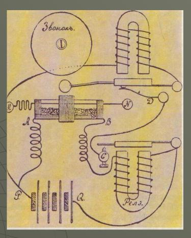
Сила тока в катушке электромагнитного реле возрастает, и реле включает электрический звонок. Так регистрировался прием э/м волны антенной. Молоточек эл. звонка, ударяя по когереру, встряхивал опилки и возвращал его в исходное положение приемник снова был готов к регистрации э/м волн.
