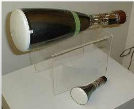
Электронно–лучевая трубка телевизоров
