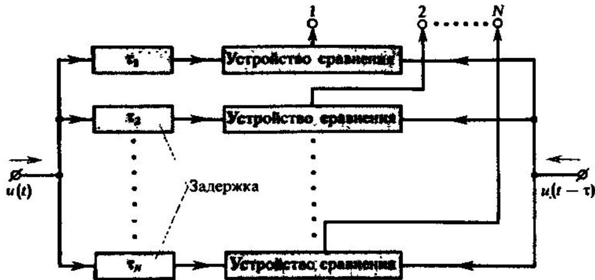
Рис. 3.3. Устройство для измерения времени задержки сигналов
