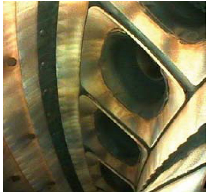
Внутренние полости КС на экране видеоэндоскопа
