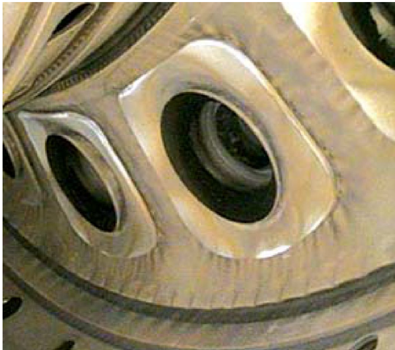
Снимок внутренних поверхностей камеры сгорания, сделанный при помощи XLG0
