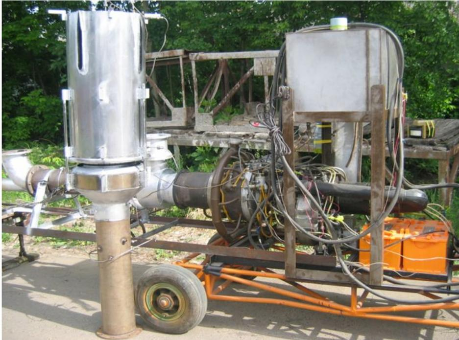
**Назначение:** Спроектированная система газовыхлопа газотурбинных двигателей позволяет снизить температуру продуктов сгорания до  $150^{\circ}\text{C}$ . Система газовыхлопа представляет собой осесимметричный эжектор с встроенным центральным телом. В качестве хладагента используется воздух из окружающей среды. Отличительной чертой разработанной конструкции является малый вес и габариты. По сравнению с используемым на кораблях щелевым газовыхлопом настоящий эжектор легче более чем в 5 раз.
