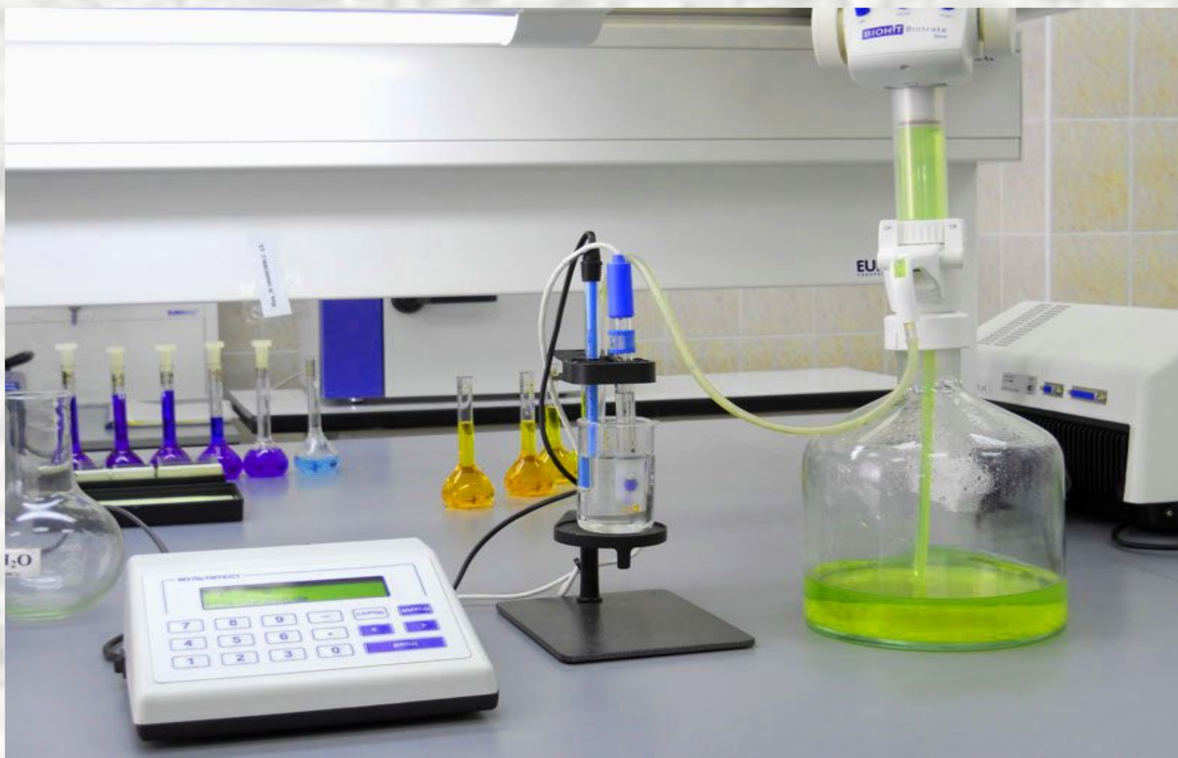
Типичная установка амперометрического титрования
