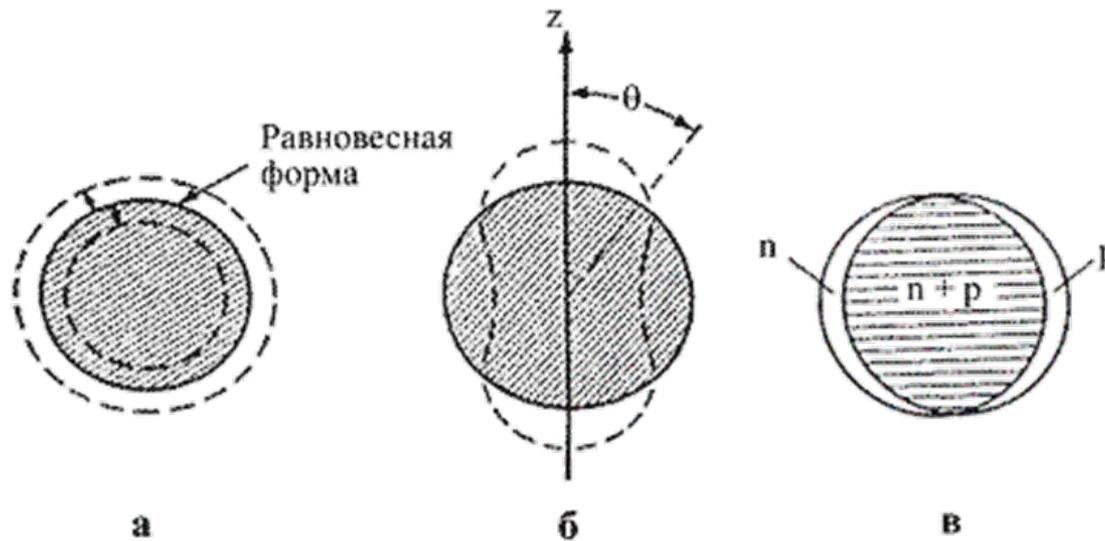
Рис. 2. Колебания ядра: а – монополярная объемная мода, б – квадрупольная поверхностная мода, в – нейтрон-протонные поляризационные колебания.
