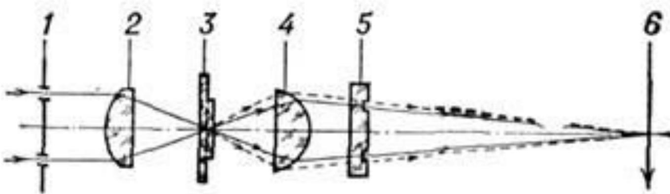
Метод фазового контраста в проходящем свете: 1 - апертурная диафрагма; 2 - конденсор; 3 - препарат; 4 - объектив; 5 - фазовая пластинка; 6 - изображение.
