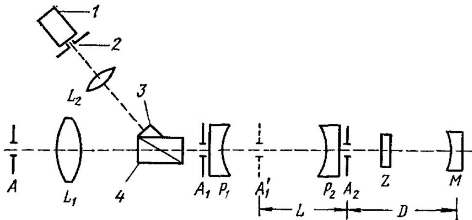
Рис. 6. Схема расположения оптических деталей в двухпроходном СИФ П<sup>20</sup>.
