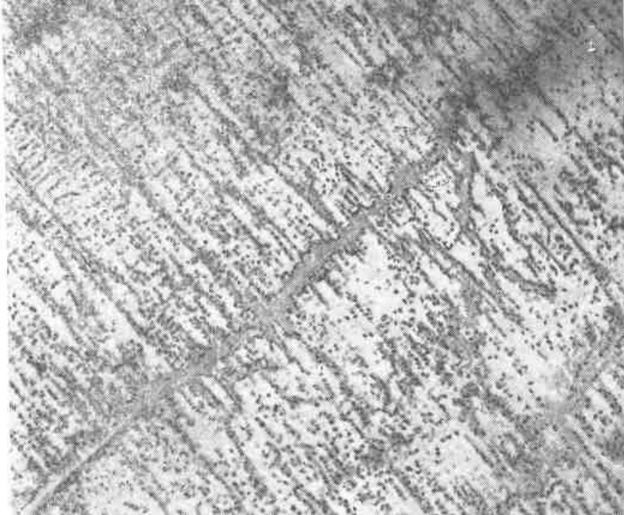
Рис. 4.9. Ямки травления на поверхности кристалла меди, деформированного на 1,5% растяжением (X140)
