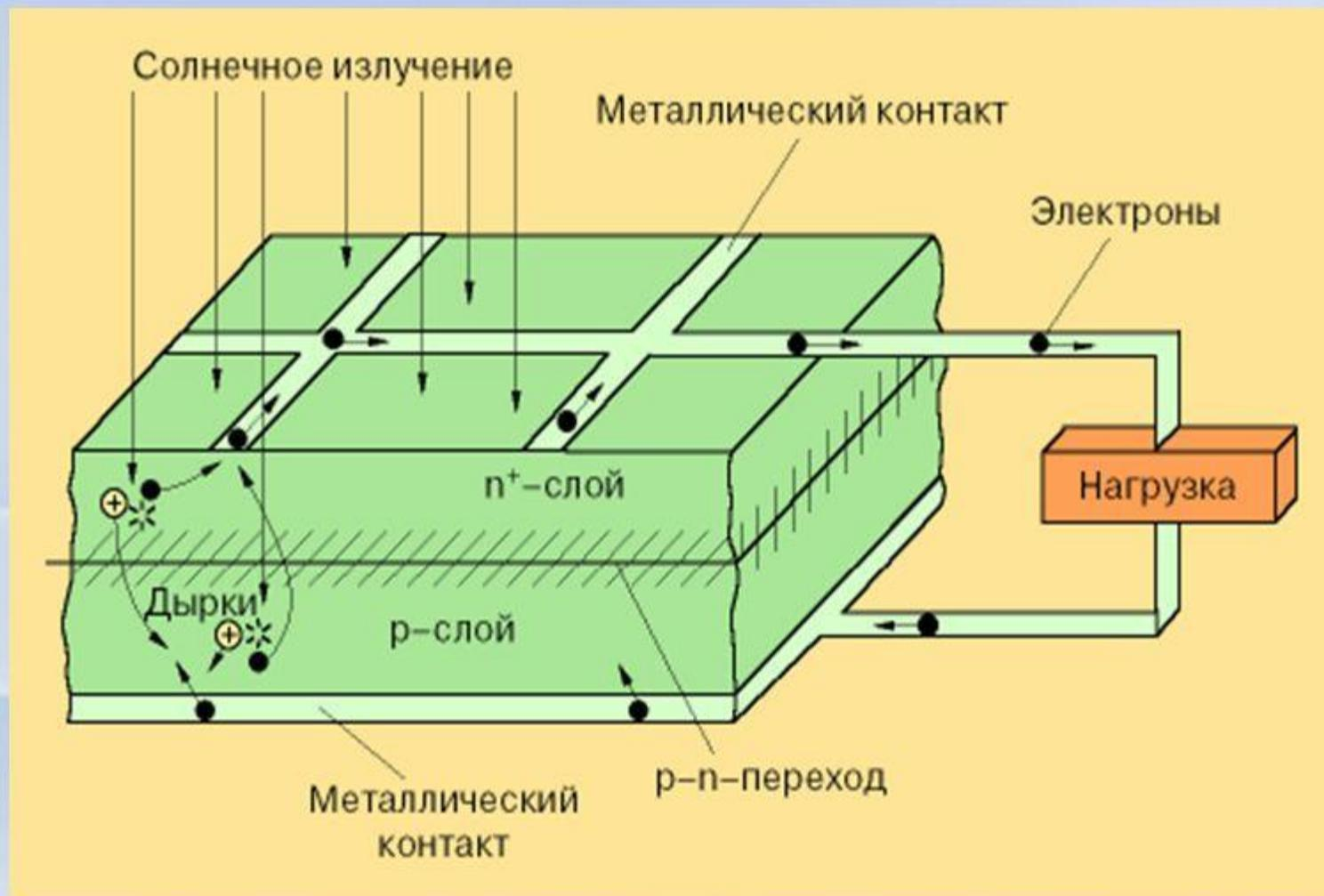
Фотоэлемент - электронный прибор, в котором в результате поглощения энергии падающего на него оптического излучения генерируется ЭДС
