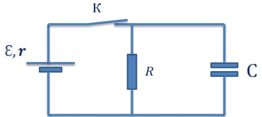
В электрической схеме, показанной на рисунке, ключ  $K$  замкнут. ЭДС батареи  $\varepsilon=12\text{ В}$ , емкость конденсатора  $C=0,2\text{ мкФ}$ . После размыкания ключа  $K$  в результате разряда конденсатора на резисторе выделяется количество теплоты  $Q=10\text{ мкДж}$ . Найдите отношение внутреннего сопротивления батареи к сопротивлению резистора.
