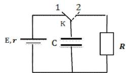
"Долгое время"  $\Rightarrow$  конденсатор максимально заряжен до  $u_c = E$
