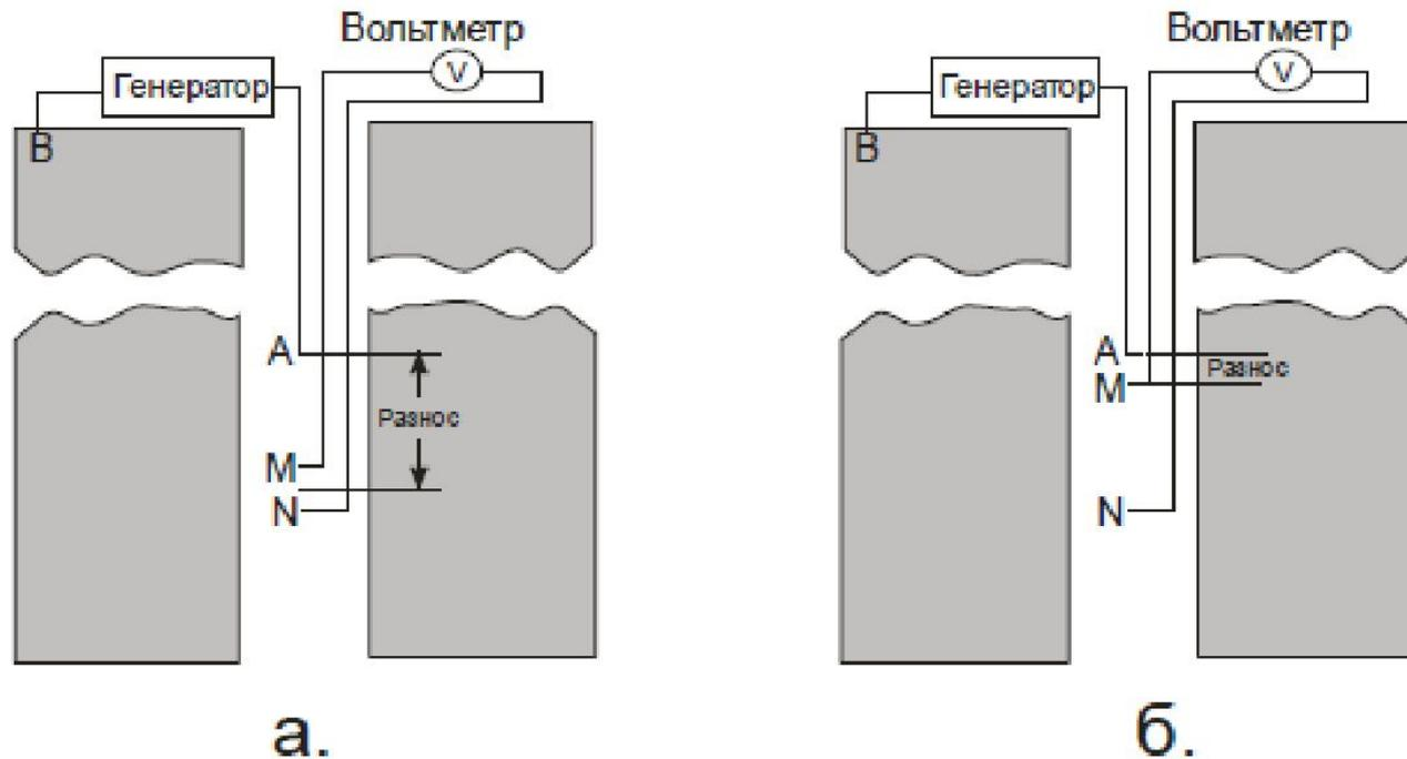
Рис. 8.6. Градиент-зонд (а) и потенциал-зонд (б) каротажа сопротивления.
