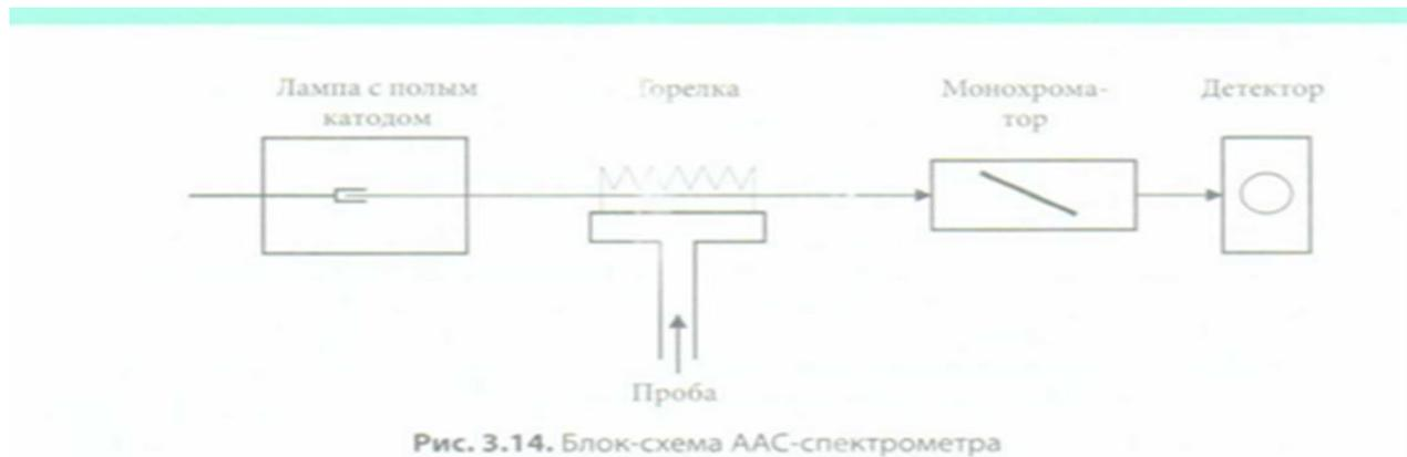
После прохождения излучения свинца **ЛПК** через пробу (горелку или печь) излучение передается на монохроматор, назначение которого заключается в выделении излучения только с определенной длиной волны и передаче его на детектор, где осуществляется определение (детектирование) сигнала анализируемого компонента.
