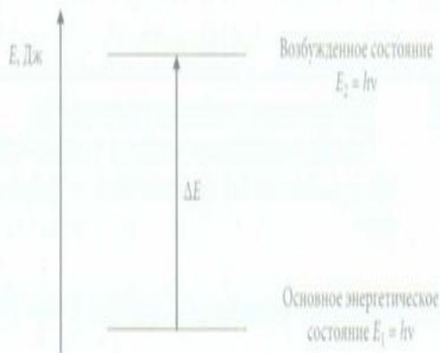
Рис. 3.5. Схема процесса абсорбции излучения при поглощении энергии E_2 - E_1 = \Delta E = h\nu
