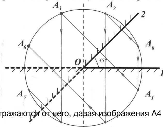
Построение изображений в угловом отражателе
