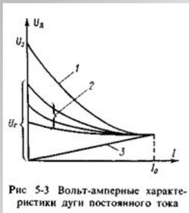
Рис 5-3 Вольт-амперные характеристики дуги постоянного тока
