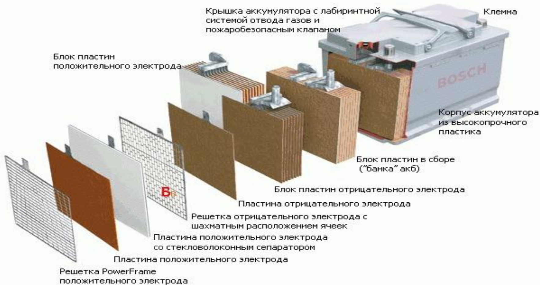
Принципиальная конструкция автомобильного аккумулятора Bosch с использованием технологии AGM
