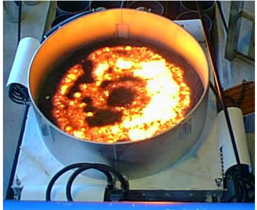
Плавка стекла в индукторе 1500 мм диаметром EFD Induction
