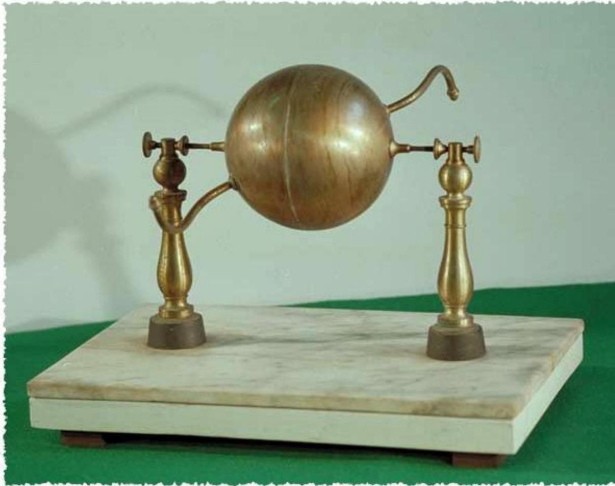
Герон Александрийский – греческий механик и математик. Одно из его изобретений носит название Шар Герона. В шар наливалась вода, которая нагревалась огнем. Вырывающийся из трубки пар вращал этот шар. Эта установка иллюстрирует реактивное движение.
