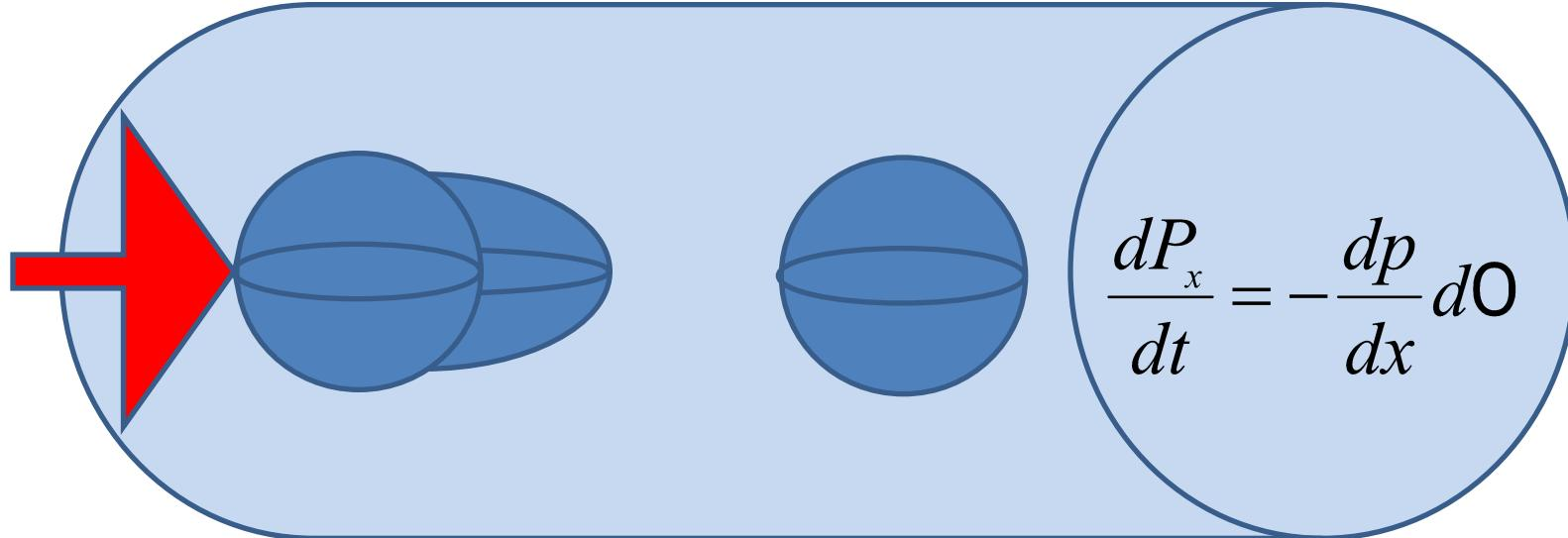
Контрольной поверхностью движущегося объема называется неподвижная поверхность  $\sigma$  в данный момент ограничивающая рассматриваемый движущийся объем.
