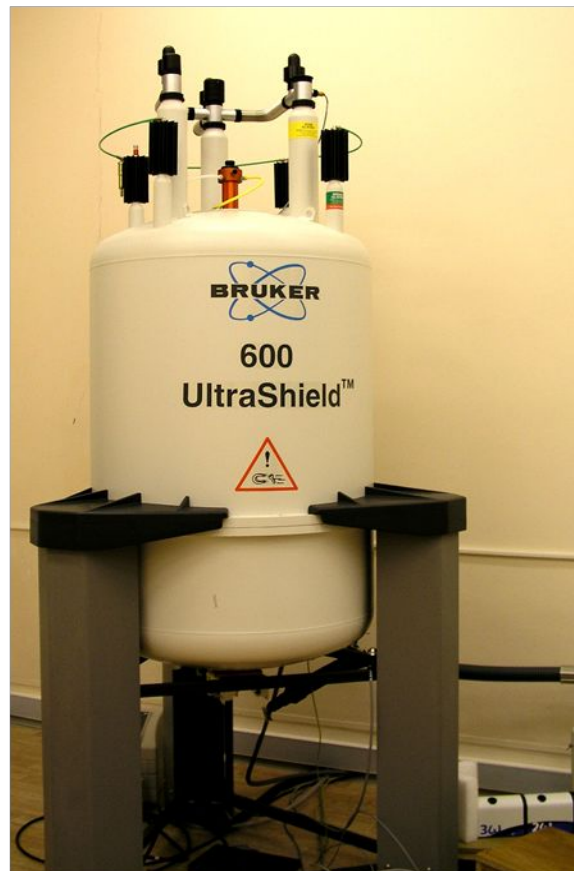
Магнит спектрометра Bruker AVANCE 600 МГц в Центре магнитной томографии и спектроскопии МГУ
