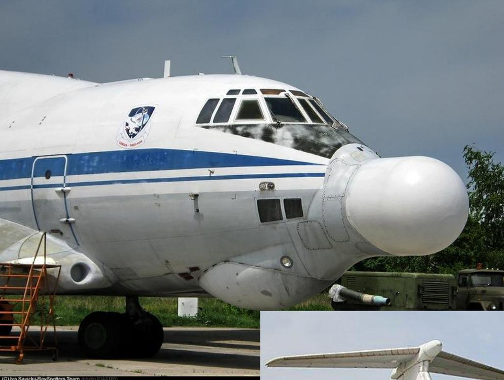
Самолет-летающая лаборатория Ил-76МД СССР-86879 (1989 г.) с авиационным вариантом боевого мегаваттного лазера А-60
