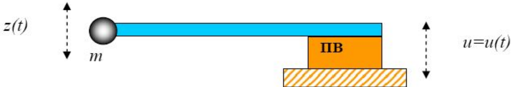
Рис. 79. Модель зондового датчика в виде упругой консоли с массой на конце
