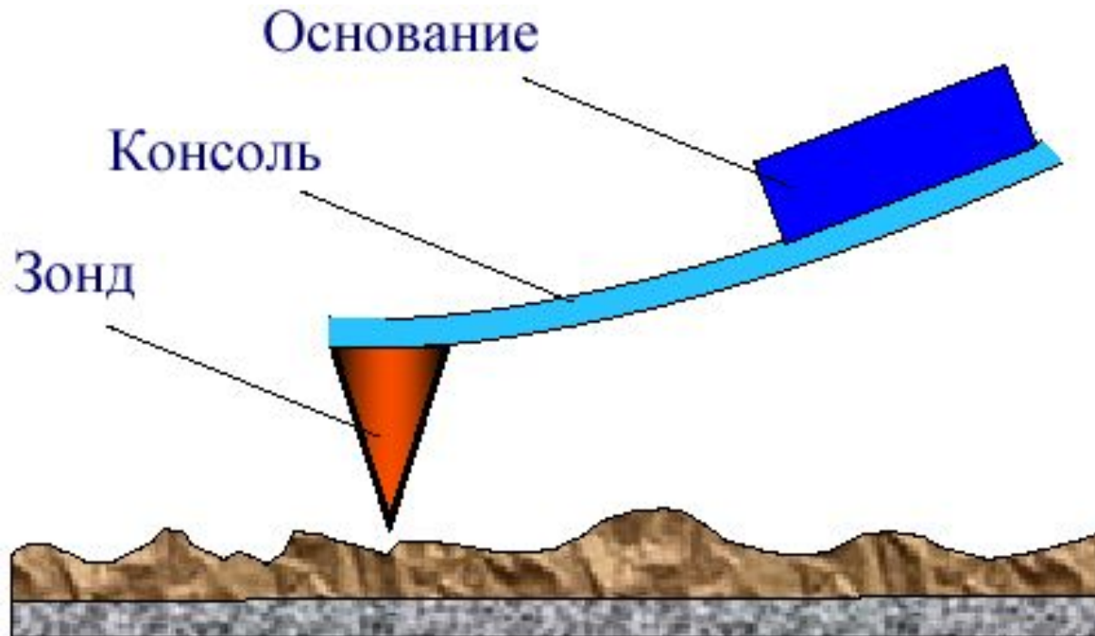
Рис . 60. Схематическое изображение зондового датчика АСМ
