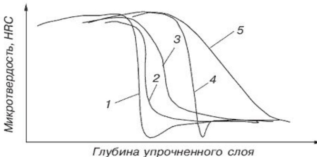
Схема изменения микротвердости сталей по глубине зоны лазерного воздействия при обработке в эгалитарных режимах:
