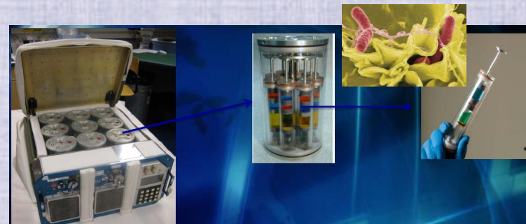
Коммерческие биотехнологические эксперименты на АС МКС с использованием биореакторов Group Activation Pack (GAP) компании Astrogenetix США (вакцины против сальмонеллы, стафилококка MRSA)
