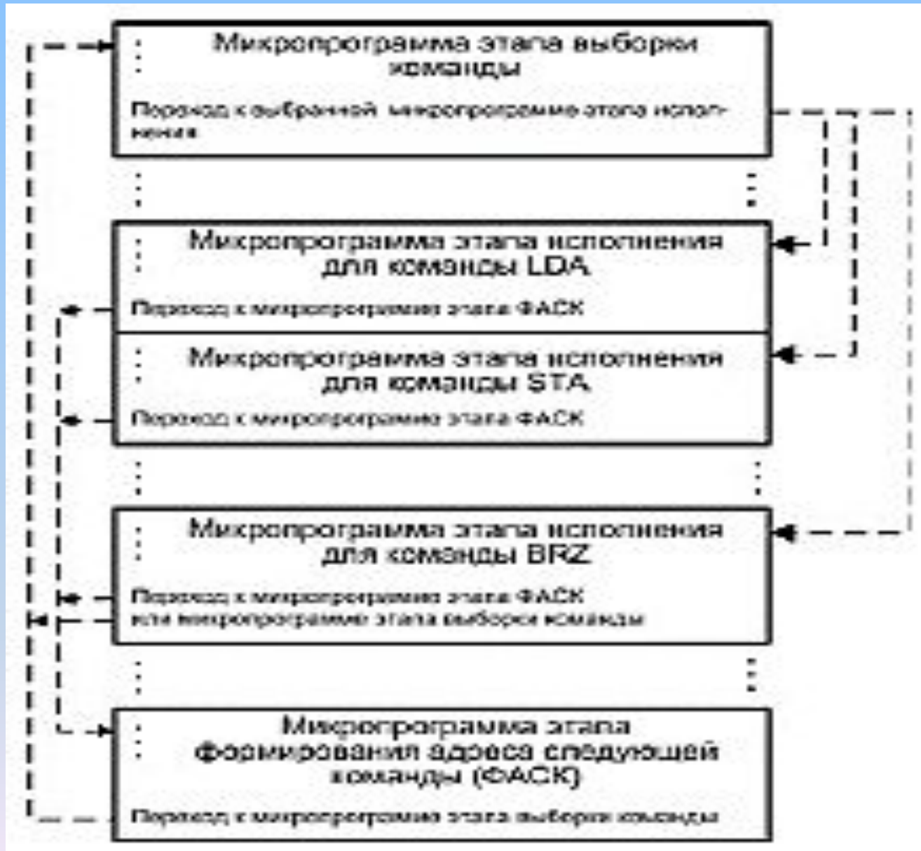
Рис. 2.6. Размещение микропрограмм в управляющей памяти
