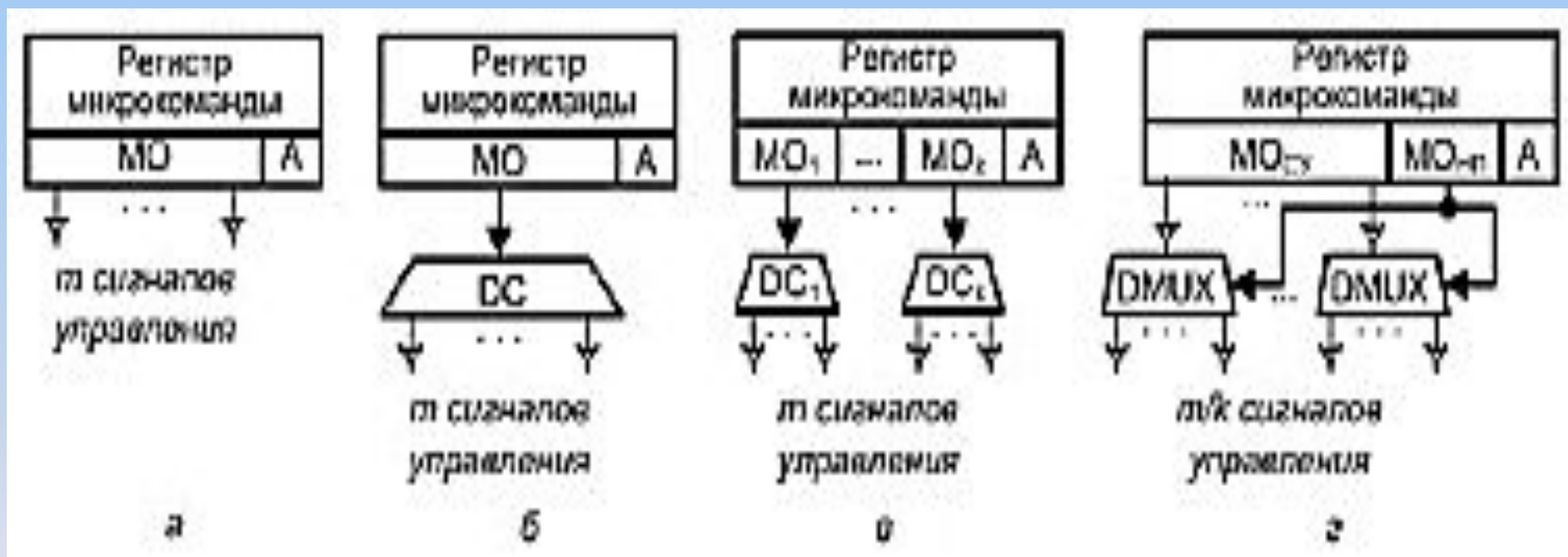
Рис. 2.9. Способы кодирования микроопераций: а – горизонтальный; б – вертикальный; в – горизонтально-вертикальный; г – вертикально-горизонтальный.
