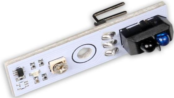
Переменный резистор, установленный на сенсоре, позволит регулировать чувствительность сенсора в широких пределах. Это позволяет откалибровать датчик под вашу конструкцию, материал покрытия и различные условия внешнего освещения. Выходным результатом работы сенсора является аналоговый сигнал. Чем светлее поверхность под сенсором —
