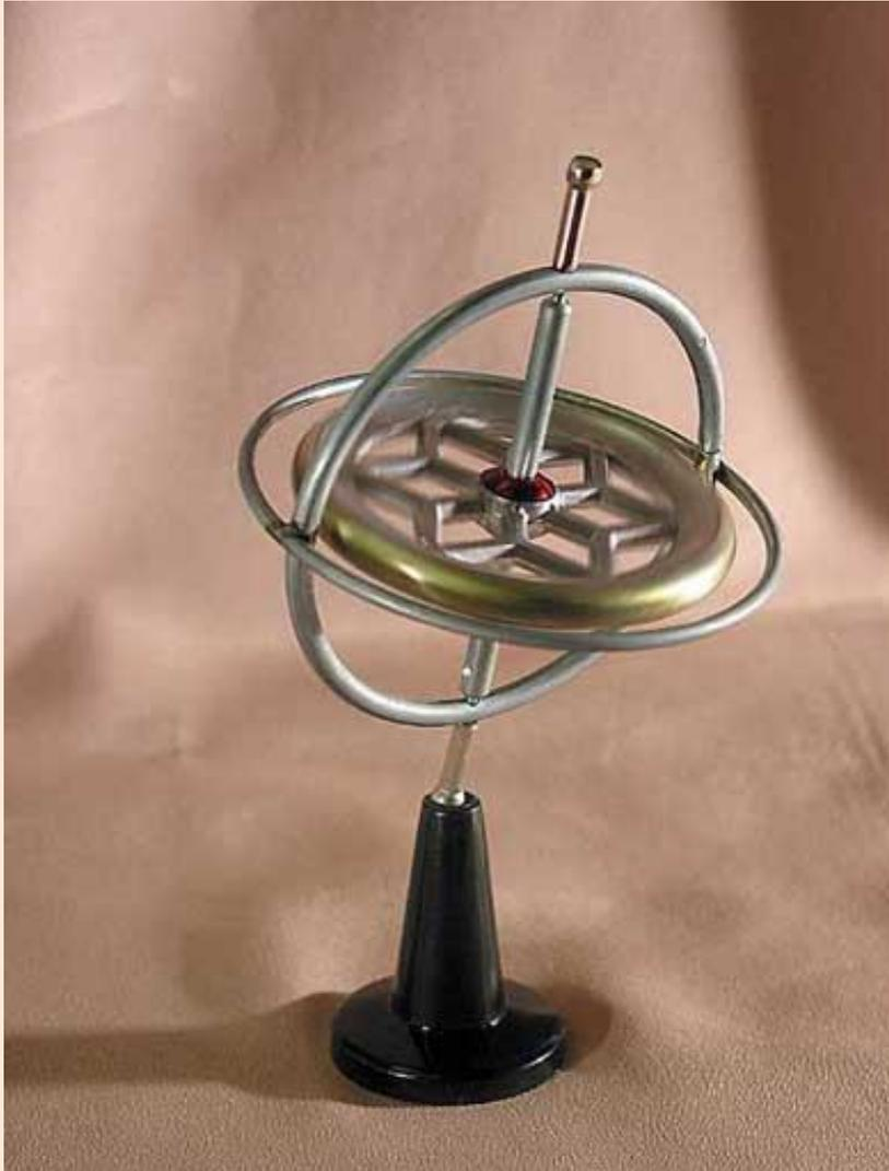
Гироскоп - это массивное симметричное тело, вращающееся с большой угловой скоростью вокруг оси симметрии.
