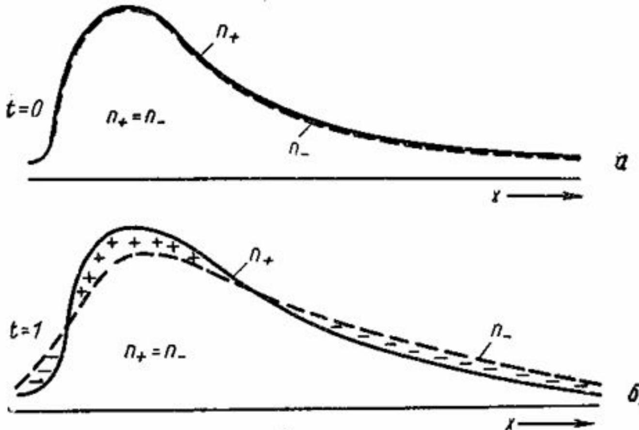
Рис. 3.60. Распределение заряженных частиц, создающее поле пространственного заряда.
