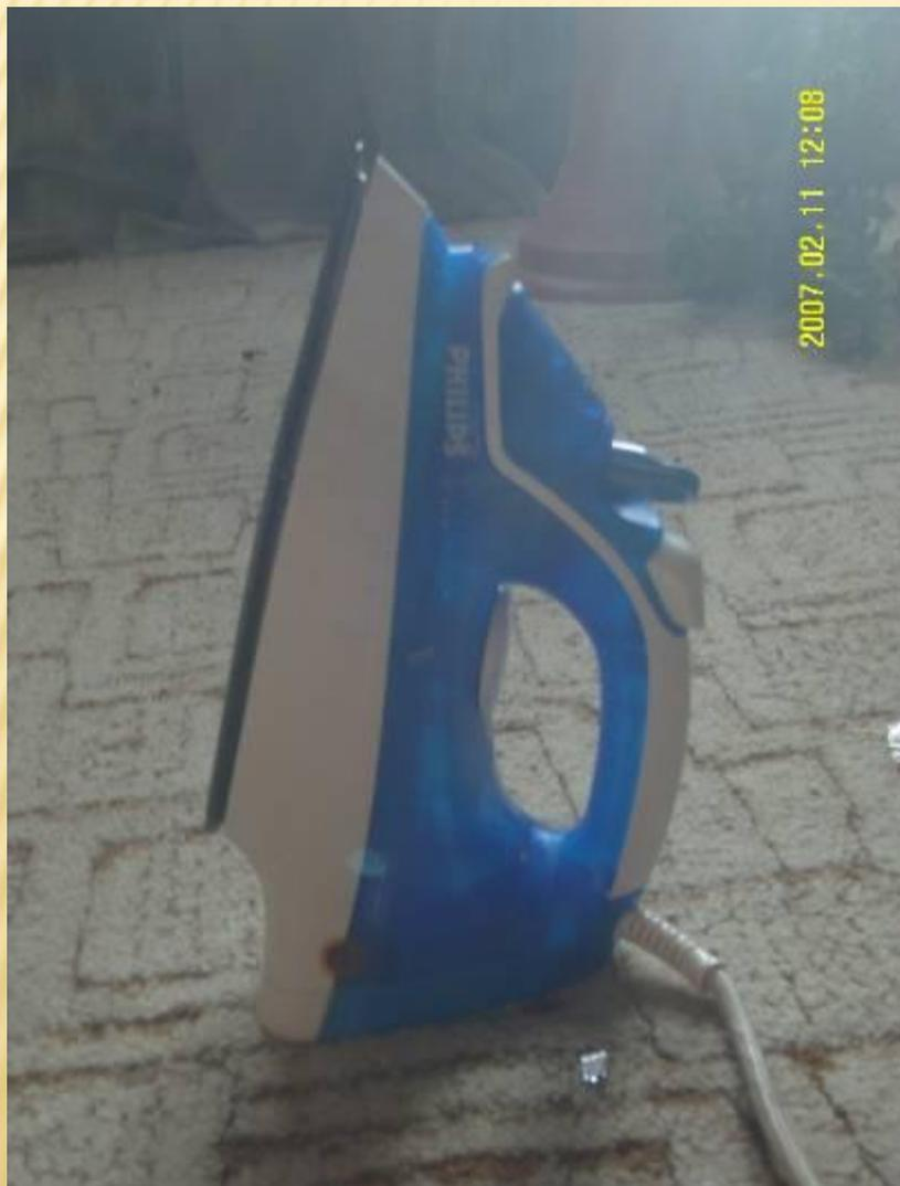
Тепло от утюга к разглаживаемой вещи передаётся в основном за счёт теплопроводности, поэтому подошву утюга изготавливают из материала, обладающего хорошей теплопроводностью, например из металла, а остальную часть корпуса и ручку изготавливают из материала, обладающего плохой теплопроводностью, например из пластмассы. Это позволяет человеку не
