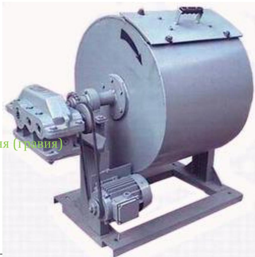
Полочный барабан КП 123А предназначен для определения истираемости щебня (гравия) по ГОСТ-8269-87. Прочность щебня (гравия) определяют по разнице массы зёрен до и после истирания пробы с металлическими шарами в полочном барабане.
