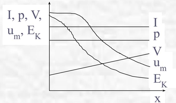
В плоской струе расход нарастает  $\sim \sqrt{x}$ , а осевая скорость и поток кинетической энергии уменьшается  $\sim 1/\sqrt{x}$ . Более медленное затухание плоской струи объясняется меньшей поверхностью соприкосновения с окружающей средой и меньшей интенсивностью вовлечения окружающей среды в движение.
