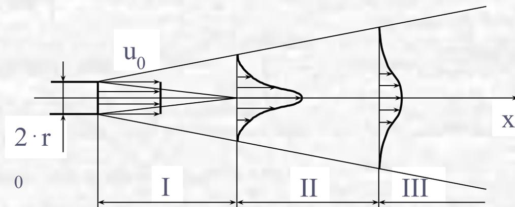
Начиная со среза сопла, в струе образуется свободный турбулентный погранслой, расширяющийся из-за поперечного переноса импульса как в сторону неподвижной окружающей среды, так и в сторону невозмущенного потока внутри струи.
