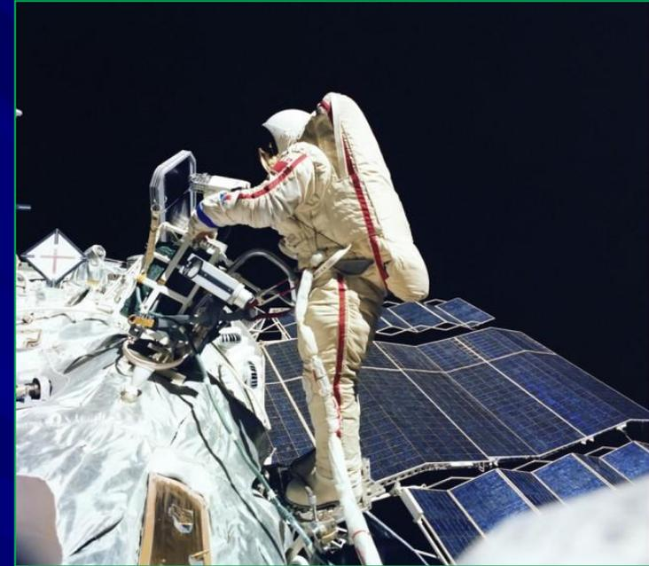
14 июля 1984 г. космонавтами С.Савицкой и В. Джанибековым были впервые проведены эксперименты по электронно-лучевой сварке с выходом в открытый космос. Применялся сварочный аппарат УРИ (универсальный ручной инструмент). Он позволял осуществлять *сварку, резку, пайку, нагрев металла, нанесение покрытий*. Все эти операции выполнялись короткофокусной электронно-лучевой пушкой, которую космонавт держал в руке.
