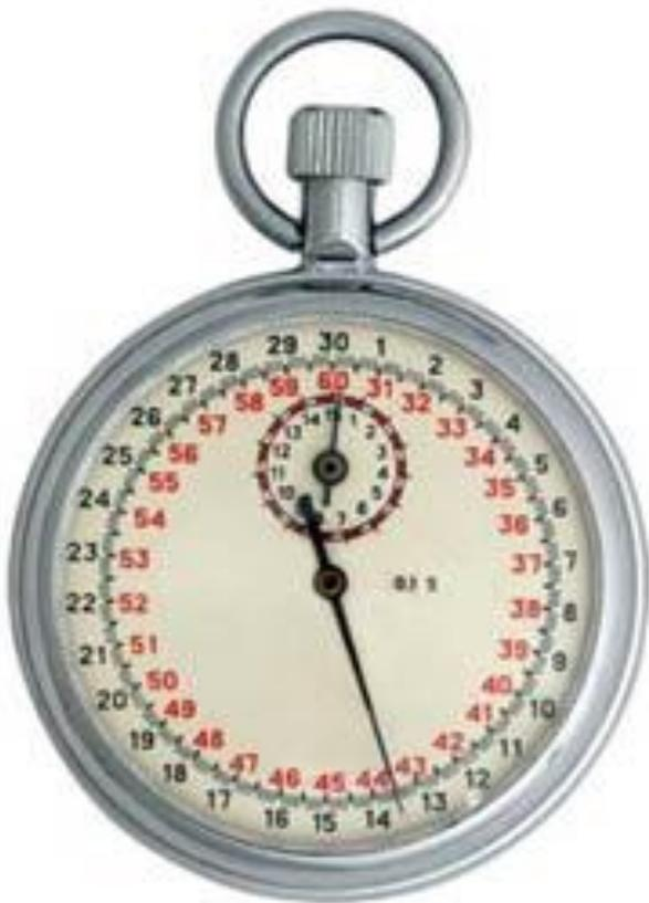
Секундомер механический имеет **30-ти секундную шкалу** с ценой деления **0,1с** и **15-ти минутный счетчик** с ценой деления **1 мин.**
