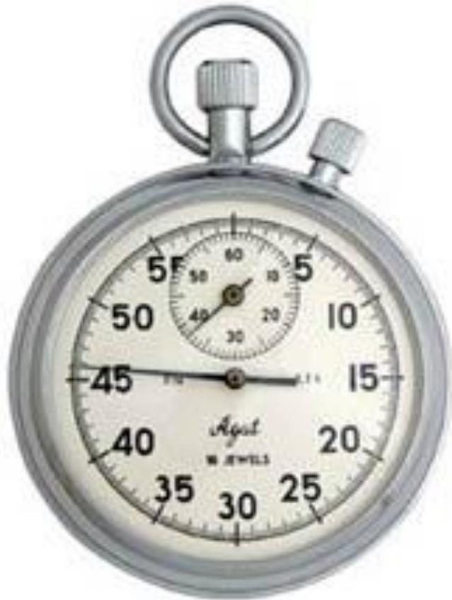
Для управления стрелками механизм секундомера снабжен специальным **устройством суммирующего действия**. Пуск, остановка стрелок осуществляется нажатием на заводную головку, возврат на нуль – нажатием на кнопку. Секундомер имеет **60-секундную шкалу** с ценой деления **0,2 с** и **60-минутный счетчик** с ценой деления **1 мин**.
