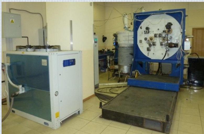
Установка вакуумной металлизации бусофита
