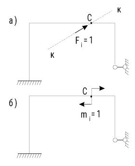
Выбор фиктивного (единичного) состояния обусловлен видом искомого перемещения. Так, например, при определении линейного перемещения точки C оси рамы в направлении "к-к" соответствующим фиктивным состоянием является рама с приложенной в этой точке силой  $F_i = 1$  с линией действия по "к-к", а при определении угла поворота оси стержня в сечении C - прикладывается пара с моментом  $m_i = 1$ .
