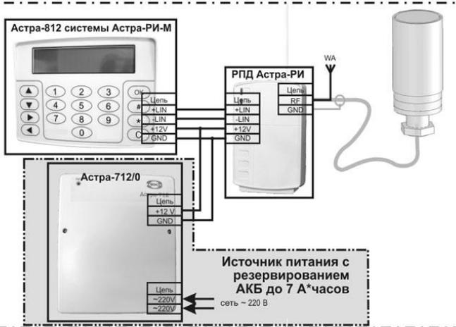
Передающая часть системы Астра-РИ, для передачи информации о состоянии ППКОП Астра-712/х проводной ОПС объекта на удаленный пост охраны
