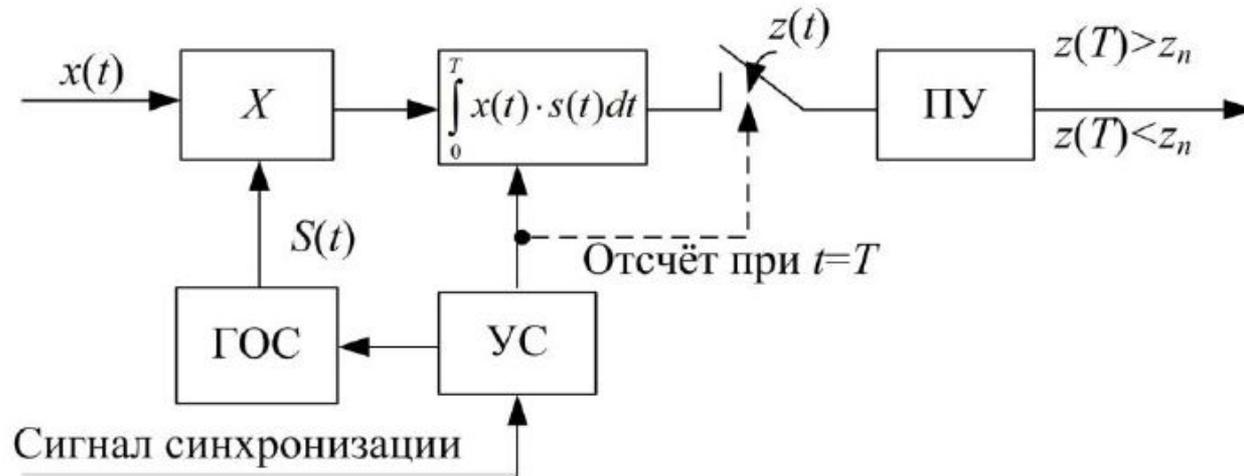
В пороговом устройстве (ПУ) производится сравнение значения корреляционного интеграла в момент ожидаемого окончания действия сигнала  $S(t)$  с порогом  $z_n$  и принимается решение о наличии или отсутствии сигнала. Начало интегрирования и его окончание совпадают по времени с началом и окончанием ожидаемого сигнала  $S(t)$ , что
