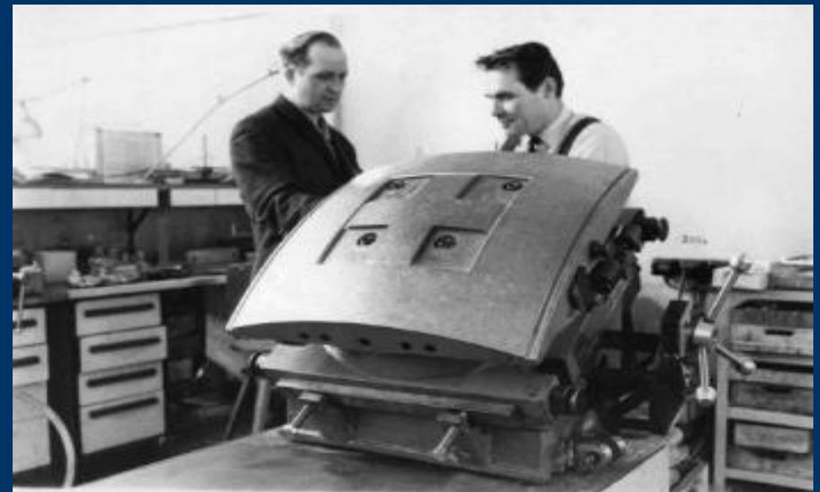
*Трение при перемещении имеет жидкостной характер. Масса как бы плавает на масле. Идеальные условия работы опоры возникают тогда, когда пленка имеет равную толщину. Это достигается регулировкой поступления масла во всех четырех пазах подушки.*
